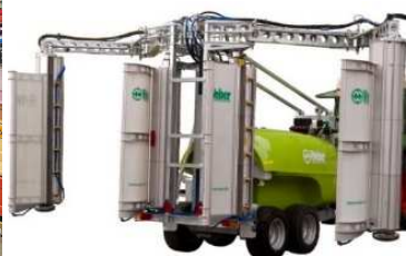
WEBER – descentes avec panneaux récupérateurs
